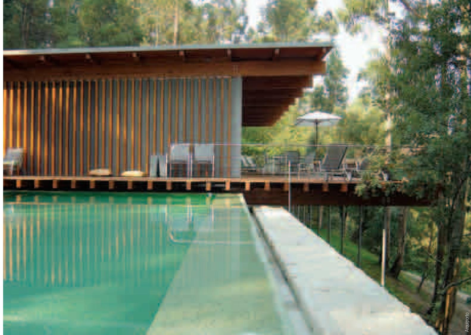
Isto porque este sistema modular não toca no terreno nem aí se enterra, implantando-se sobre uma estrutura elevada, essa sim ancorada no solo através de distanciadores metálicos, quase ao estilo palafítico (sobre estacas), o que permite a sua implantação em qualquer tipo de relevo topográfico, indiferente que é a declives.
